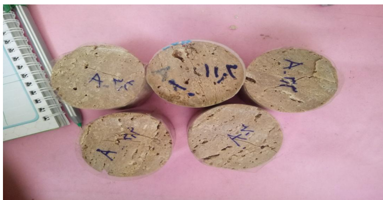
شکل ۶- وضعیت نمونه‌ها بعد از آزمایش کششی برزیلی
