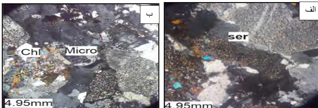
شکل ۴-۴ (نمونه شماره ۲) بلورهای کوارتز و پلاژیوکلاز و فلدسپار آلکالن و حاوی تعدادی بیوتیت که تبدیل به کلریت‌های آبی رنگ شده است (ب) و همچنین پلاژیوکلازهای سریسیتی در آن مشاهده می‌شود (الف) که نشانگر دگرسانی سریسیتی می‌باشند.
