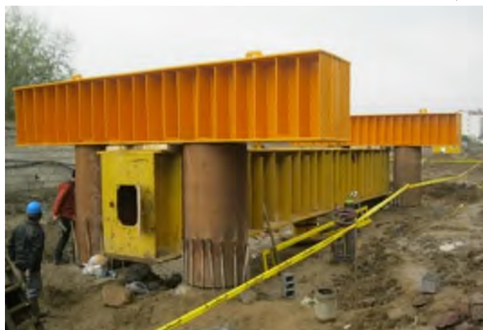
شکل ۶- تصویری از بارگذاری شمع‌های بتنی درجا ریز (شرکت پژوهش عمران راهوار، ۱۳۹۸)
