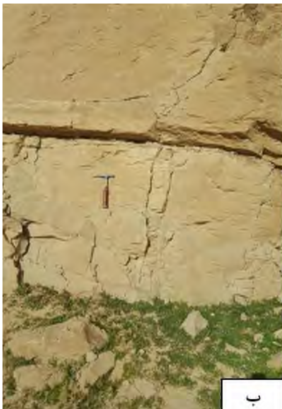
شکل ۵. الف) درزه J1 با تداوم جانبی زیاد ب) درزه J2 در لایه‌های ماسه‌سنگی
