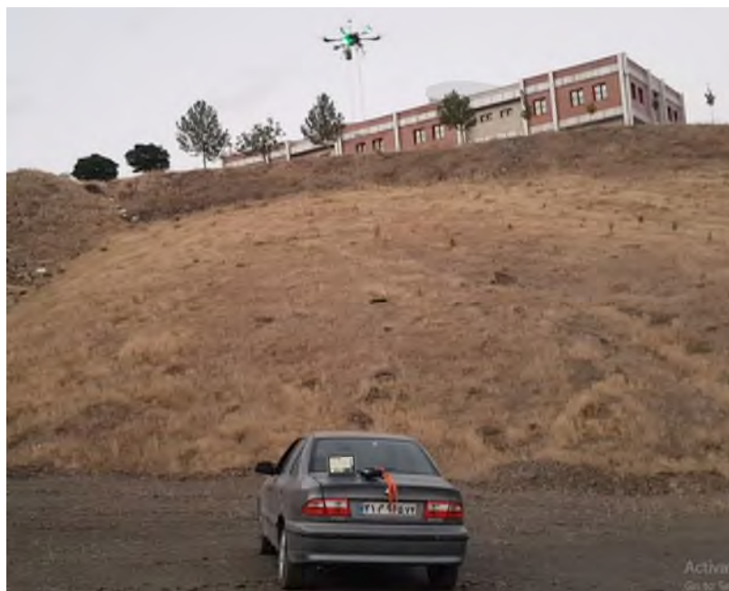
شکل ۳. عبور پهپاد از روی خودرو به عنوان یک بی‌هنجاری فلزی (مکان: محوطه دانشگاه کردستان)
