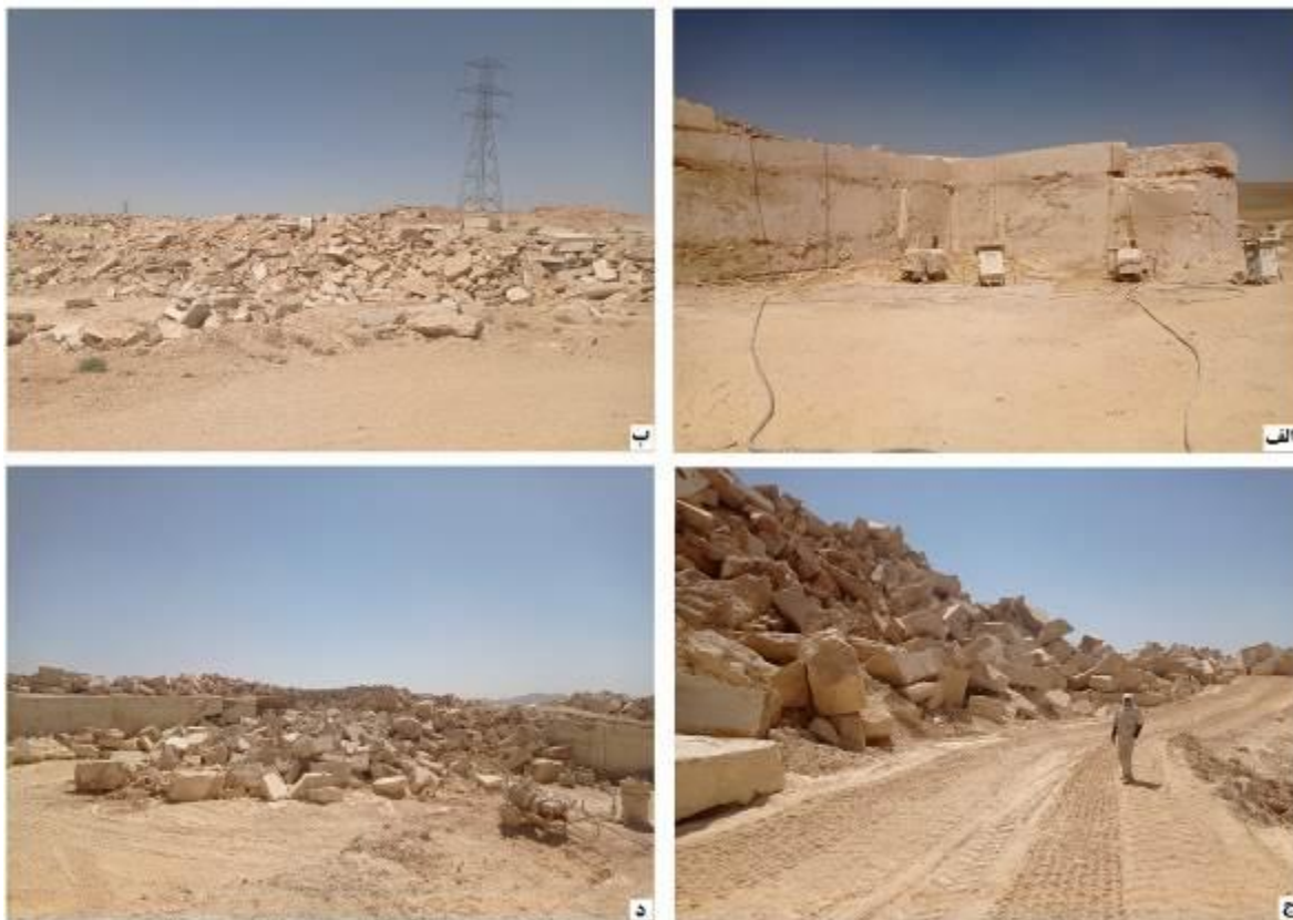
شکل ۳: الف) کارگاه استخراج فعال، سینه کار فقط جهت برداشت باطله. ب) محل دپوی باطله‌های غربی (کارگاه استخراج غیرفعال) باطله‌های زیاد. ج) اندیس مرکزی (کارگاه استخراج غیرفعال) باطله های زیاد. د) وجود باطله های حجیم و سنگین در داخل معدن و اطراف آن.
