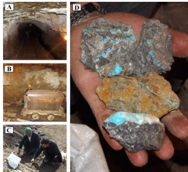
شکل ۵: مراحل استخراج کانی فیروزه در معدن فیروزه نیشابور
