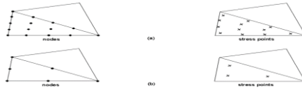
شکل ۷: نواحی مثلثی و محل قرارگیری نقاط مورد محاسبه تنش و تغییر مکان در روش حل عددی اجزاء محدود
