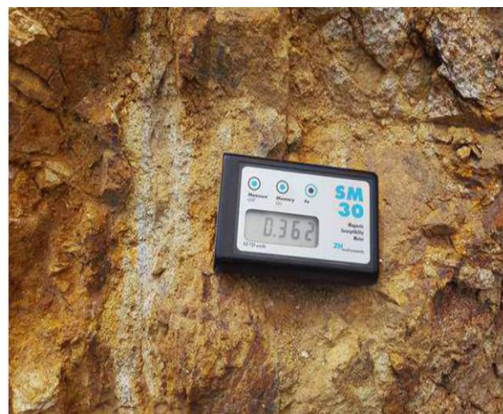
شکل ۵. خودپذیری مغناطیسی بر روی دو رخنمون از منطقه که تفاوت بالای خودپذیری را احتمالاً به خاطر میزان دگرسانی نشان می‌دهند.
