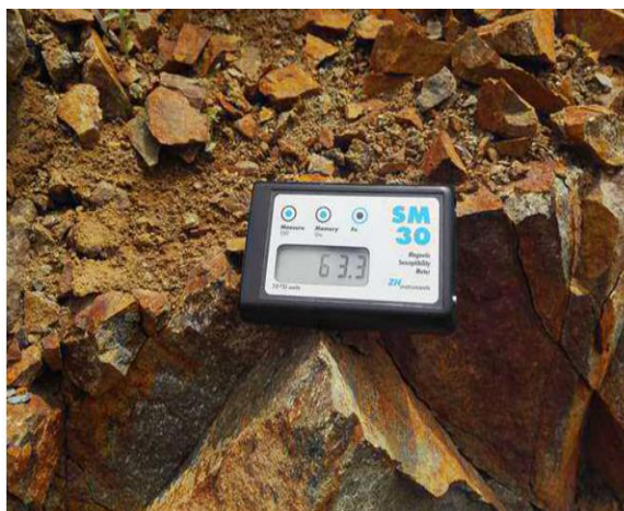
شکل ۵. خودپذیری مغناطیسی بر روی دو رخنمون از منطقه که تفاوت بالای خودپذیری را احتمالاً به خاطر میزان دگرسانی نشان می‌دهند.
