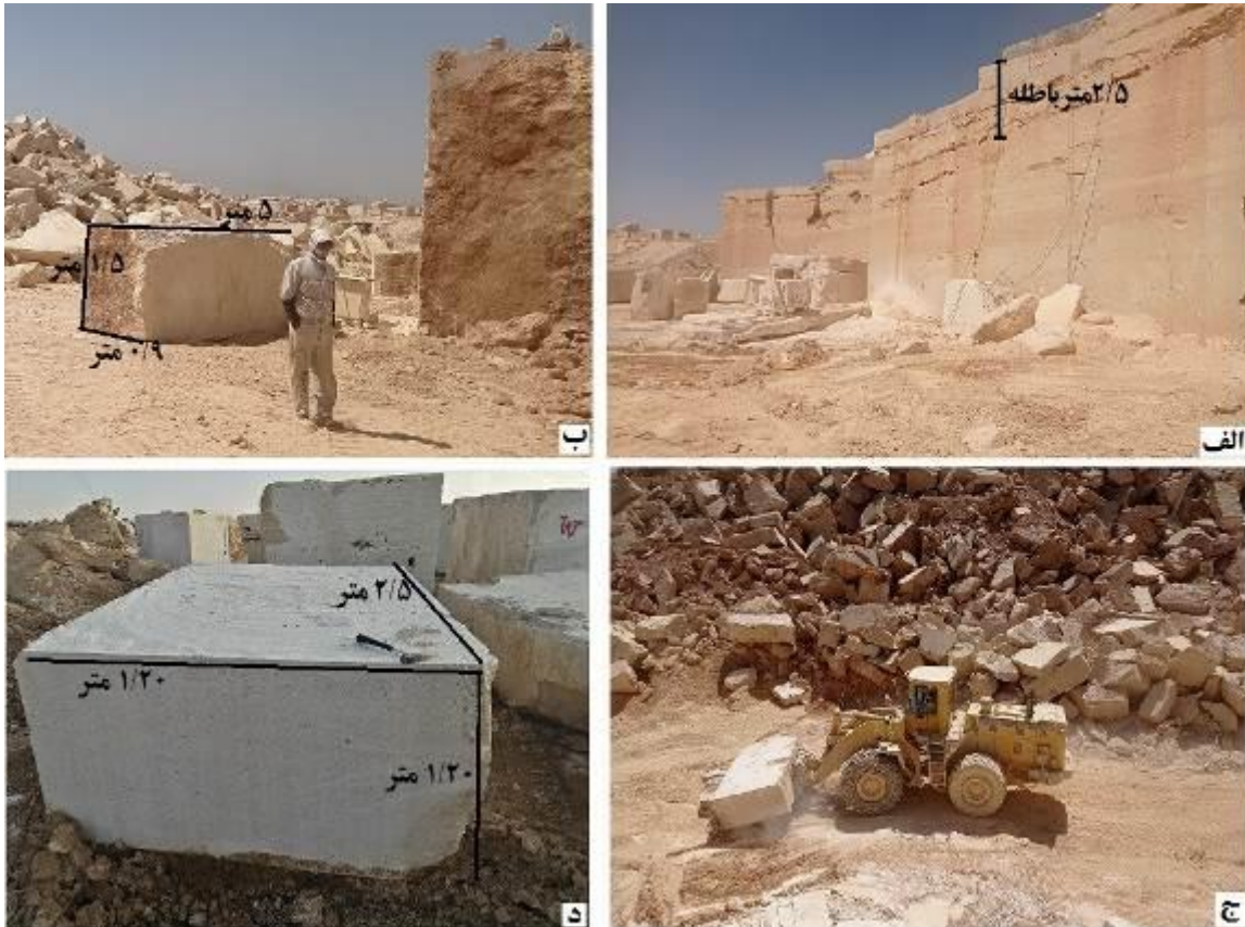
شکل ۲: الف) سینه کار شماره ۳ در معدن دینگله کهریز ۵. ب) یک بلوک در کنار سینه کار. ج) نحوه ی حمل و نقل بلوک ها با استفاده از ماشین آلات سنگین وزن در داخل معدن. د) یک قواره بریده شده از ماده معدنی
