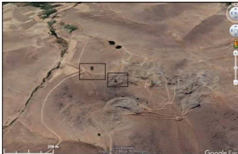
شکل ۴: الف) جریان‌ها مسیر ثابتی ندارند و به صورت نخ آب‌های پریپچ و متقاطع هستند (متأثر از فعالیت معدن‌کاری A)، ب) جریان‌های خطی در مسیر آبراهه‌ها (بدون تأثیر فعالیت معدن‌کاری B). (Google Earth, 2021).
